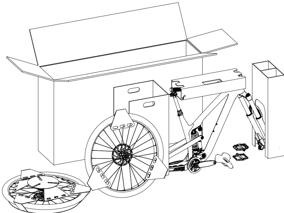
1. Fija todas las piezas sueltas o móviles o envuélvelas bien. Los componentes afilados o puntiagudos se deben envolver para que no causen daños en el interior de la caja y no puedan perforarla.
