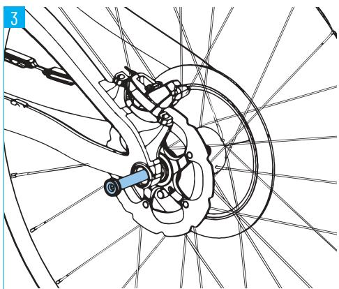
1. Mettez la roue arrière en place dans les pattes d'extrémité du cadre .
