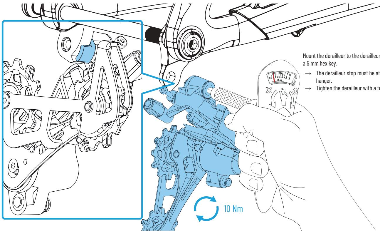
Mount the derailleur to the derailleur hanger of the frame using a 5 mm hex key.
