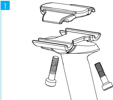
Desenrosca los tornillos de la abrazadera del sillín y retira la abrazadera superior.
