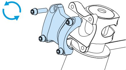
1. Destornilla los tornillos de la abrazadera de la potencia.
