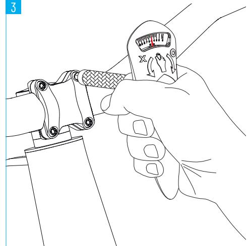
Serrez les vis avec la clé dynamométrique :
