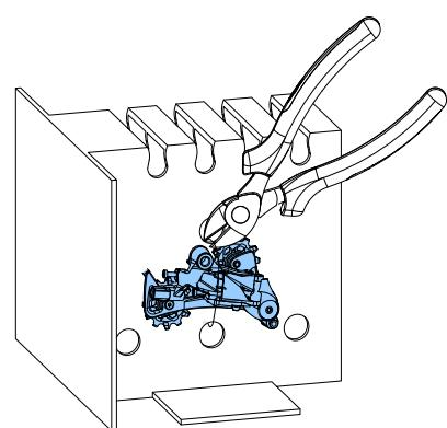
Suelte el desviador trasero de la fijación del triángulo trasero.
