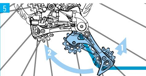
Desactiva la función Cage Lock. Para ello, tire de la caja del desviador trasero ligeramente hacia adelante y deje que el desviador trasero vuelva con cuidado a su posición original.
