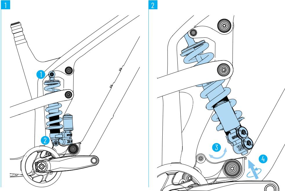
1. Desserrez et retirez tout d'abord la vis supérieure de l'amortisseur. Un léger soulèvement du triangle arrière facilite le retrait du boulon.
