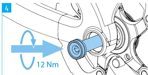
Gira el eje en el extremo con una llave Allen de 6 mm y apriétalo con un par de 12 Nm.
