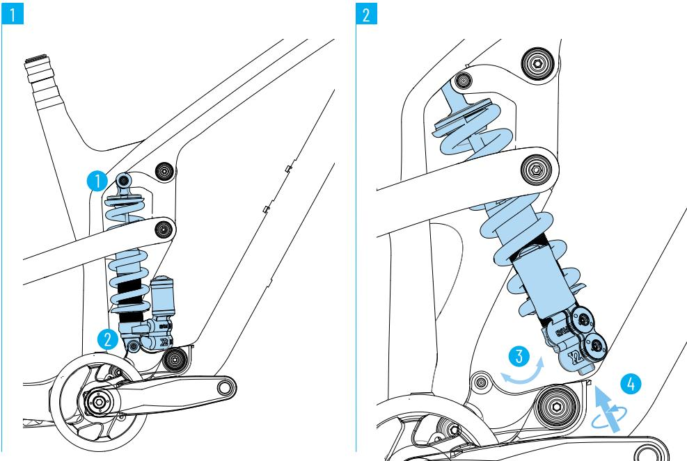
1. Primero afloja y retira el tornillo superior del amortiguador. Para facilitar la extracción del perno levanta ligeramente el triángulo trasero.
