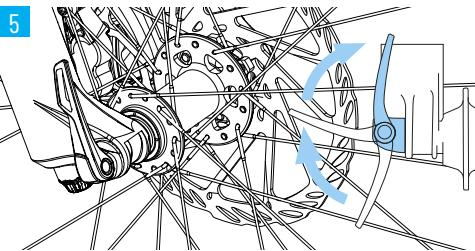
Gira el eje en la rosca del extremo hasta que entre el eje y el extremo tan solo quede un pequeño hueco.
