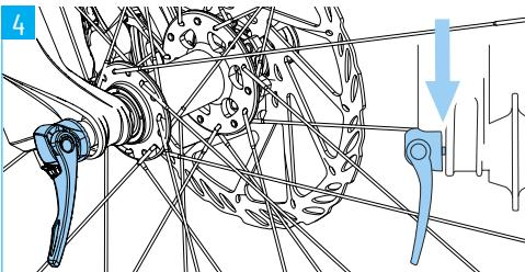
Vissez l'axe de roue dans le filetage de la patte de fourche jusqu'à ce que seul un petit interstice soit visible entre l'axe de roue et la patte de fourche.
