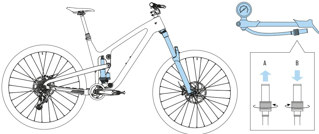
1. Desenrosca la tapa de la válvula del amortiguador/horquilla.
