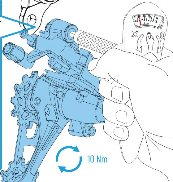
Montez le dérailleur arrière sur la patte de dérailleur du cadre à l'aide d'une clé hexagonale 5 mm.
