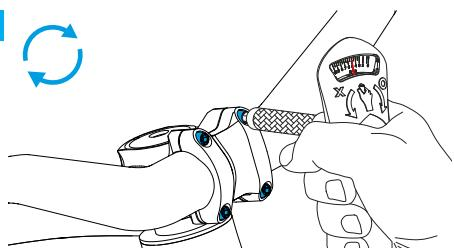
1. Coloca los dos tornillos de tope superiores y apriételos con el par de apriete grabado en láser en la abrazadera o la potencia.
