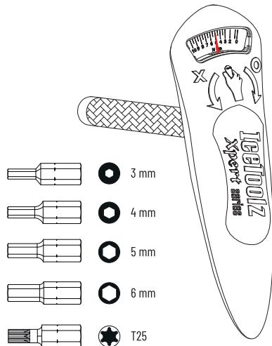
El mango de la llave dinamométrica permite colocar cinco herramientas distintas:
