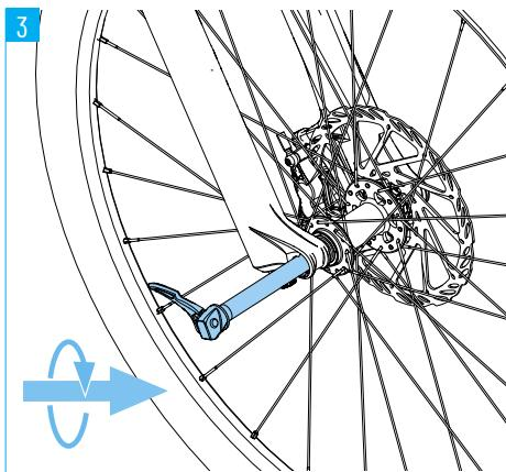
1. Introduce la rueda delantera en los extremos de la horquilla. El disco de freno debe ensartarse entre las pastillas de freno.
